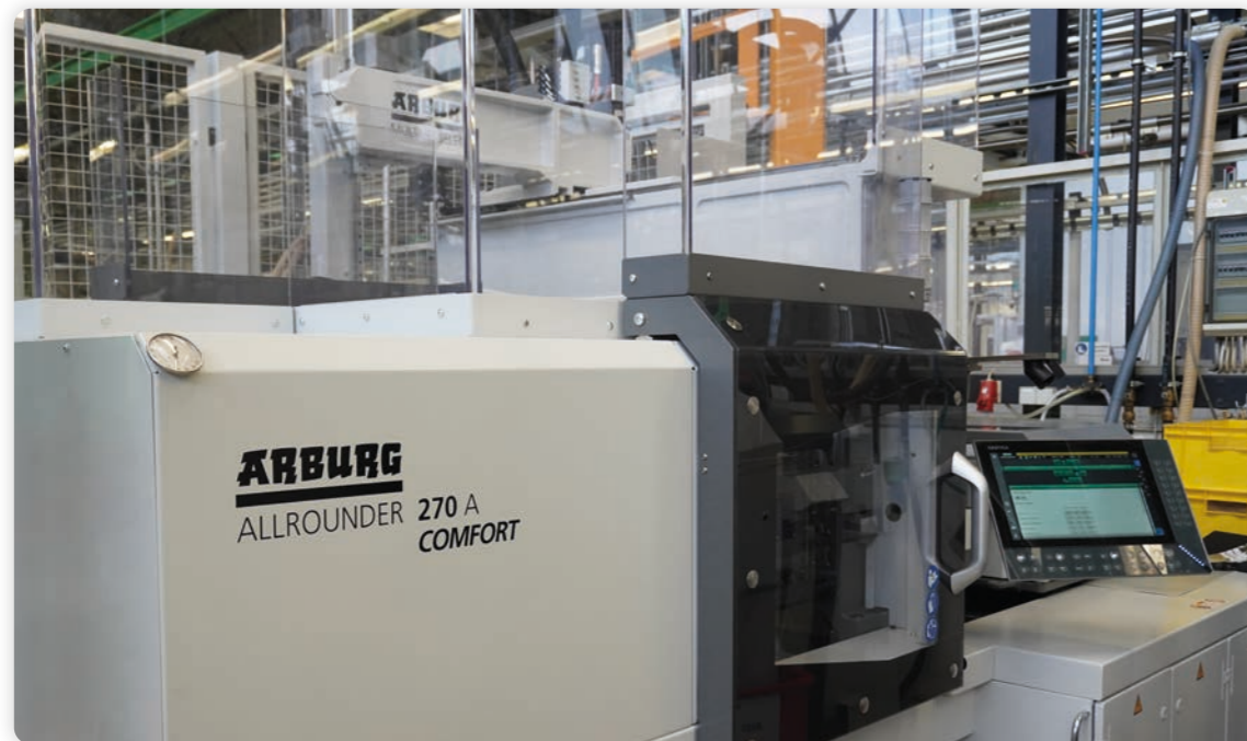
Die vollelektrische Arburg 270 A mit einem frei programmierbaren 3-Achs-Roboter
